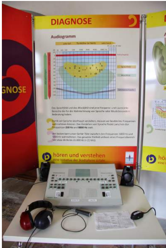
DIAGNOSE: Audiometer zum Feststellen der Hörkurve
