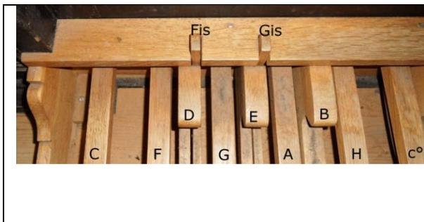
Im Bild die historische Pedal-Tastenbelegung. Ab A dann chromatisch bis a°. Die Töne *Fis* und *Gis* sind als kleine, externe Knopftasten in der Fußstützleiste des Pedals ausgeführt. Ab einer bestimmten Körpergröße sind *Fis* und *Gis* wegen des lichten Abstands zur Trägerplatte der Manualklavatur nur erschwert erreichbar.
