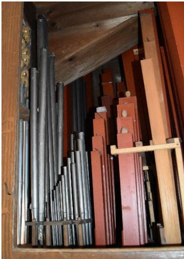
Blick ins Pfeifenwerk: Ganz links die Pfeifen, die man aus dem Kirchenraum sieht, dann folgen drei Metall- und drei Holzregister je nach Pfeifenlänge ansteigend
