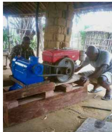
Reisschälmaschine im Aufbau blau=Schälmaschine, rot=Motor
